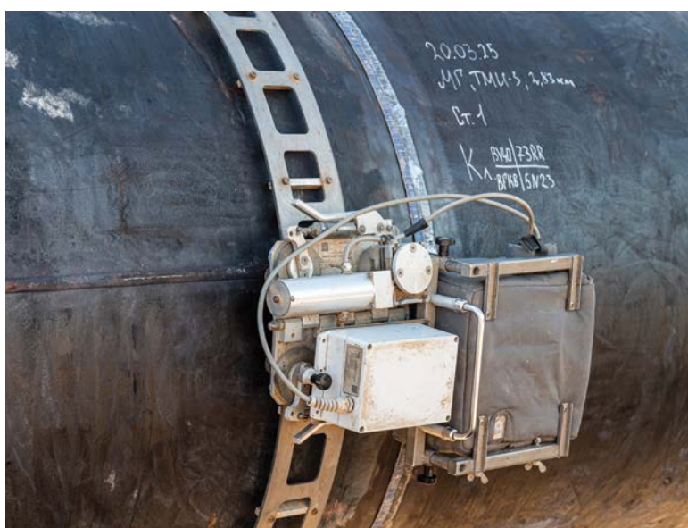
Контроль сварного соединения радиографическим методом
